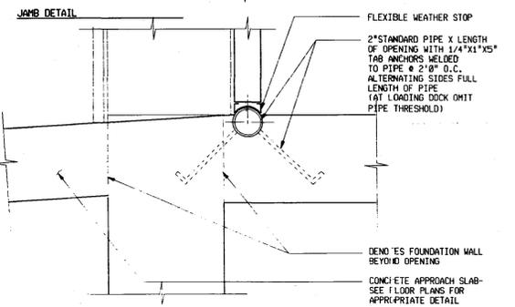
**OVERHEAD DOOR DETAIL (DOOR ON NORTH ELEVATION SHOWN)**
