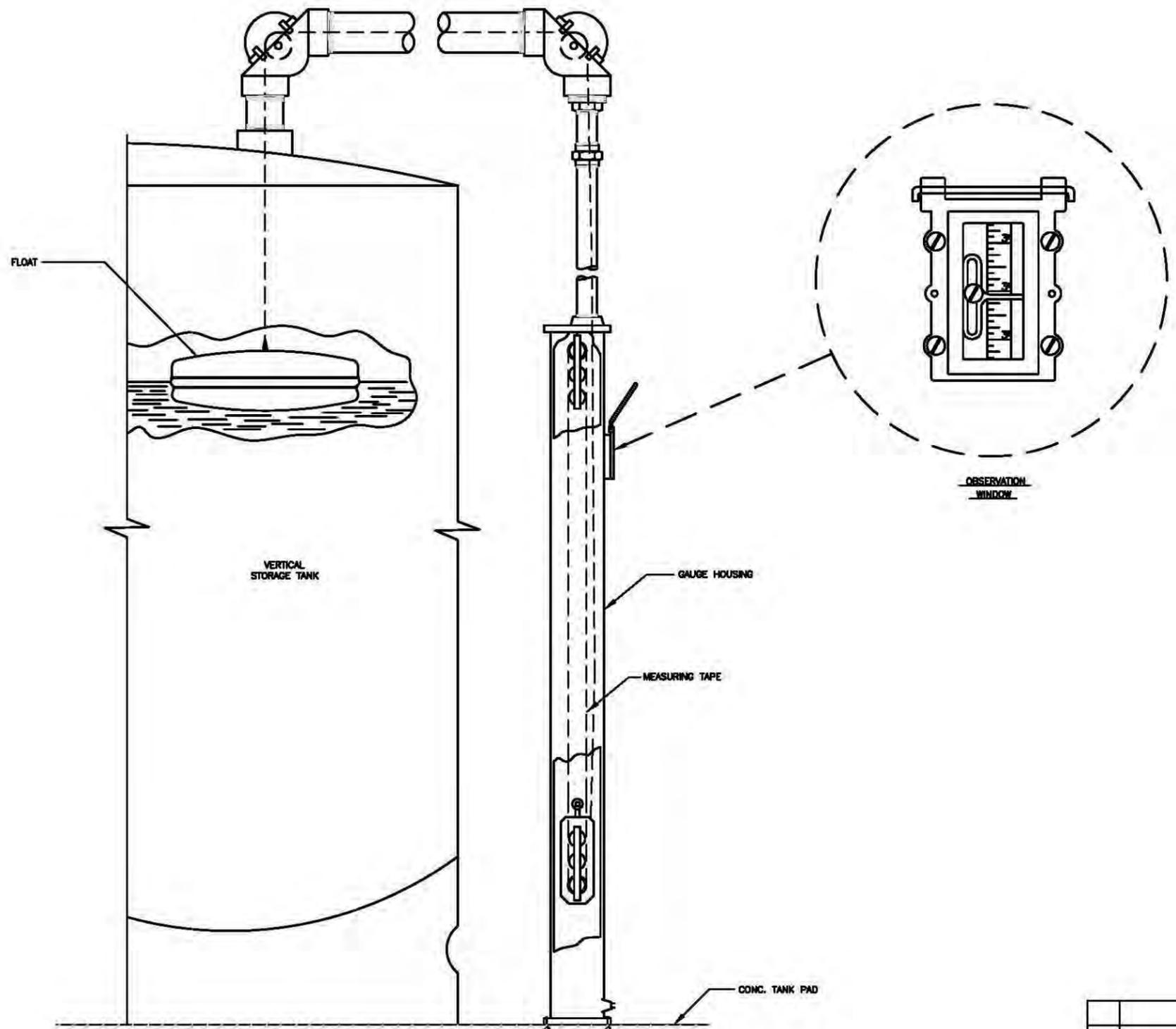
VERTICAL STORAGE TANK - GAUGE DETAIL
