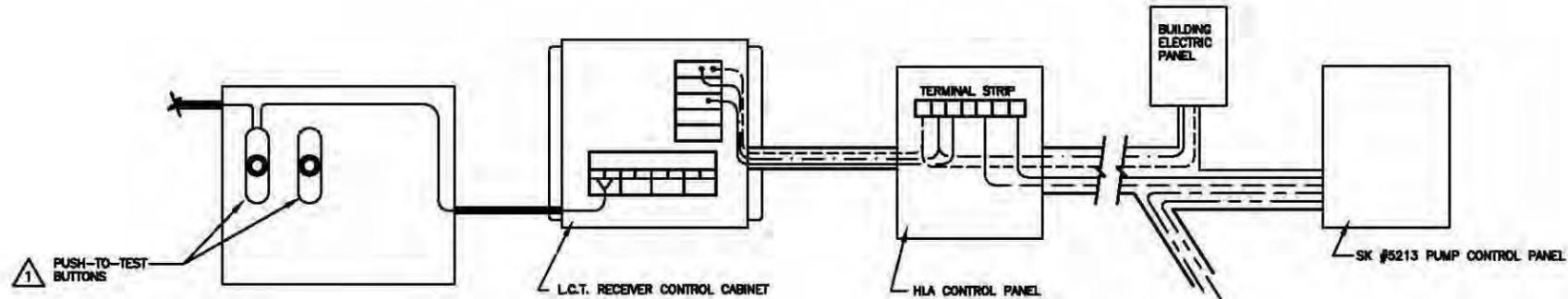
**TANK HLA SYSTEM CONTROL WIRING LAYOUT**
