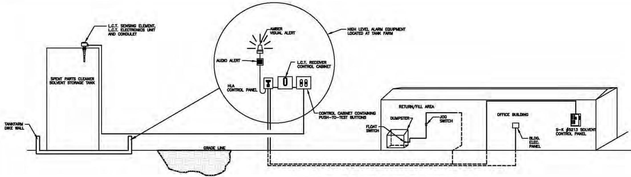
**HIGH LEVEL ALARM SYSTEM DIAGRAM**
